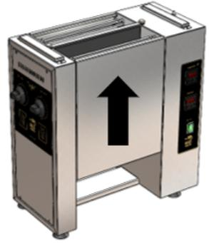
2. Encontre a emenda da esteira (gancho com a emenda menor) e com o auxílio de uma chave de fenda e alicate, remova dos eixos com as rodas.
